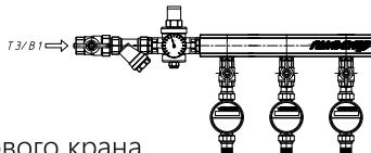
В комплекте: : без шкафа, подключение отводов слева, диаметр шарового крана и фильтра на вводе 1", редуктор давления на вводе 1", диаметр коллектора 1 1/2", количество отводов — 5, диаметр подключения отводов 1/2", без фильтра на отводах, без редуктора давления на отводах, обратный клапан на отводах, без воздухоотводчика, без дренажа, манометр.
