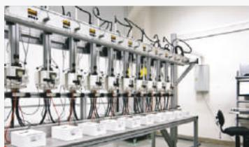
6 УСТАНОВОК ДЛЯ ПОВЕРКИ ЭЛЕКТРОСЧЕТЧИКОВ
